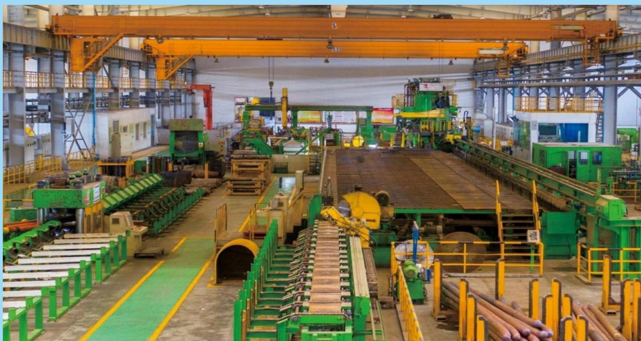
意大利55KN(5500吨)正向双动挤压机
