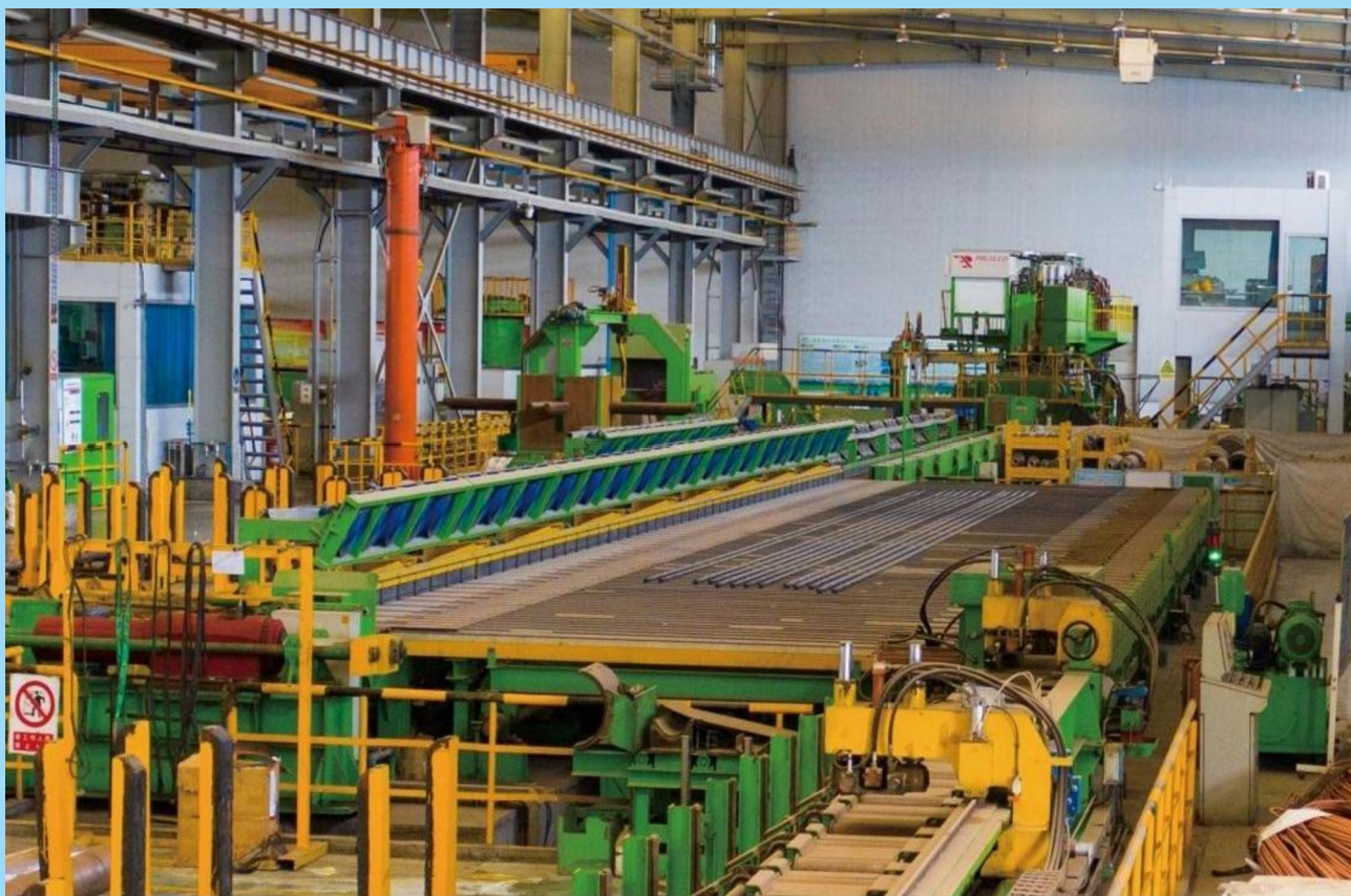
意大利35KN(3500吨)反向单动挤压机组
