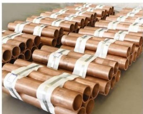
阴极辊用紫铜厚壁管
